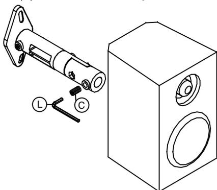
04-B) Fixe a caixa acústica no suporte com o parafuso (C) como mostra a ilustração.
