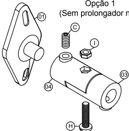
**04-B) MONTAGEM NA PAREDE:**
