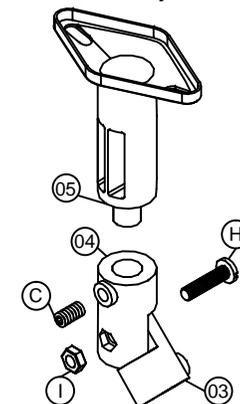
01 As bases nº1 e nº2 serão fixadas na parte traseira da caixa acústica, verifique qual melhor irá se adaptar para efetuar a montagem como mostra a ilustração.
